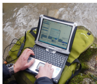
[ci-dessus et en tête de page] Jaugeage de débit sur le Chéran par radeau et doppler.
